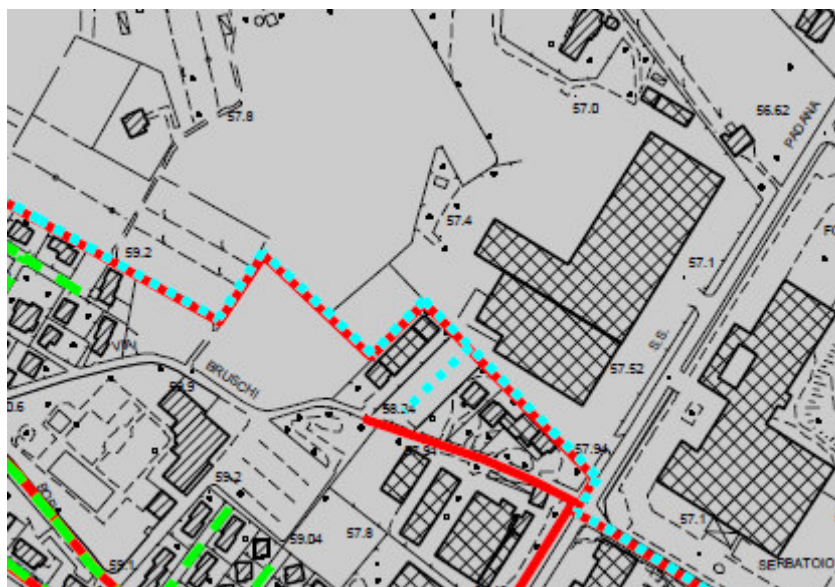
Reti fognarie nell'ambito di intervento (estratto da PRG: tratteggiata in azzurro la rete bianca, in rosso la rete nera)
